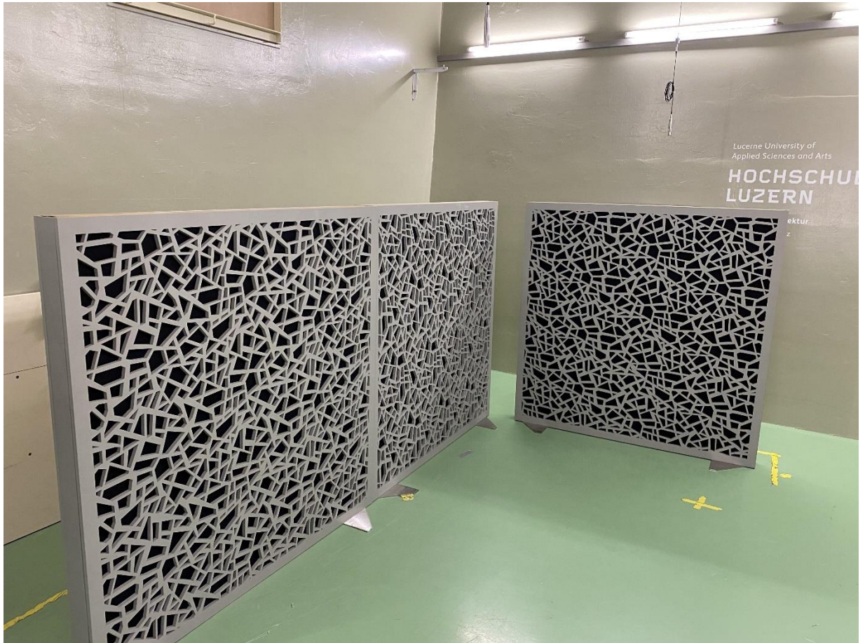
Abbildung 10: Schallabsorptionsgradmessung an den Raumteilern «Noise-Catcher» im Hallraum (Anordnung gemäss Kunde)
