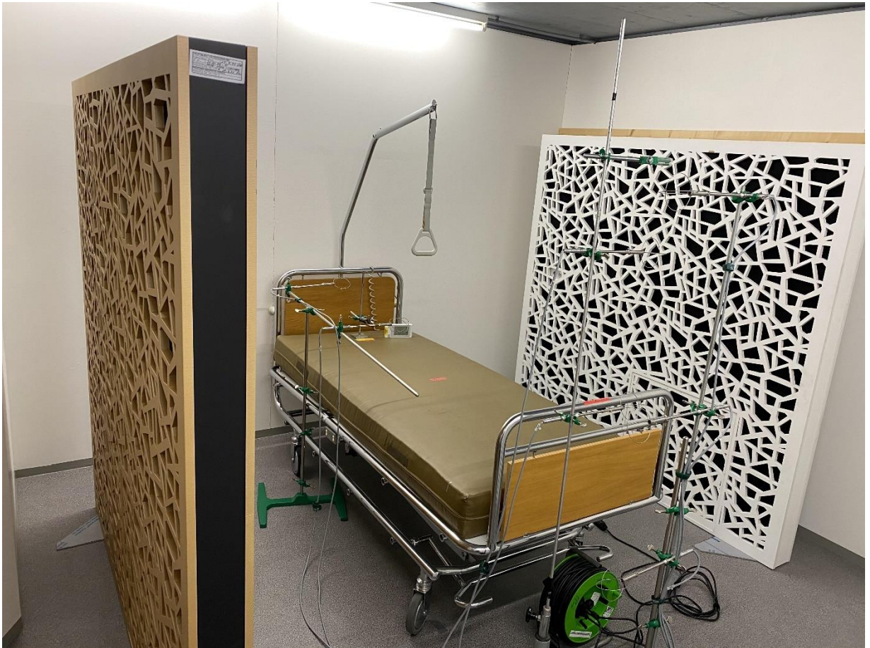
Abbildung 14: Dantec-Sonden im Isolierraum zur Messung der Raumluftgeschwindigkeit
